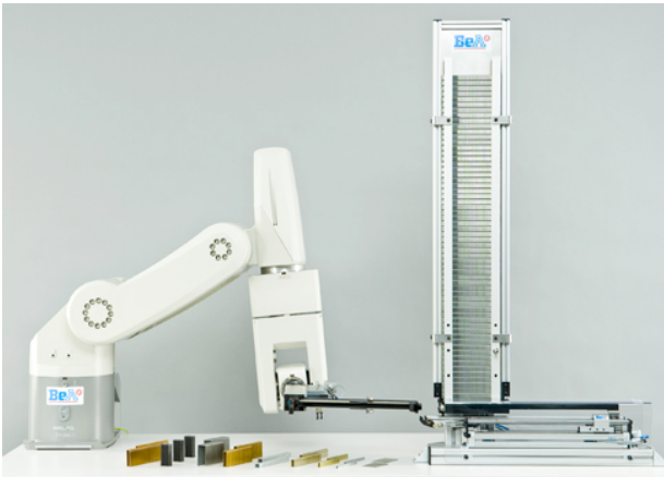
Automatischer Nachschub jetzt auch bei Senkkopfnägeln: BeA Modulanagler am Roboter mit Beladestation. Foto: BeA
