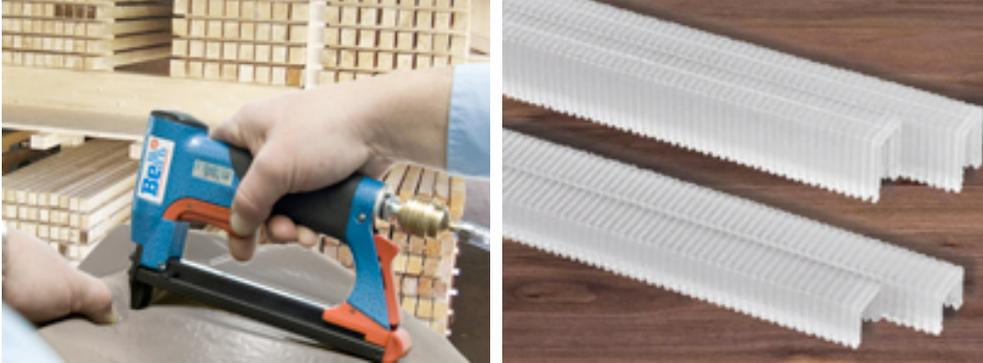
Druckluftnagler BeA P8/16-428 und Kunststoffklammern: Innovative Befestigungslösung von BeA schont Säge, Fräse, Schleif- und Hobelmaschine. Fotos (JPG, 300 dpi): BeA
