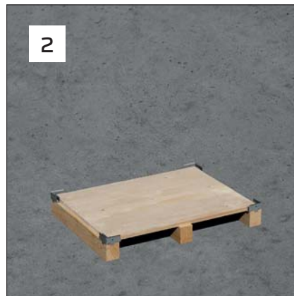
2 Palette als Basis mit BeA VTT- Verbindern
